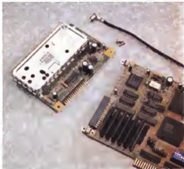
Il modulo sintonizzatore a installare all'interno della scheda.
